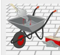
Lesen Sie den Wetterbericht, bevor Sie mit dem Verfüllen der Fugen beginnen. Mischen Sie den Inhalt in einem Mörtelkübel oder einer Schubkarre, damit die Bindemittel mit dem Quarzsand vermischt werden. Vermengen Sie nicht mehr als den Inhalt von zwei Säcken auf einmal.
