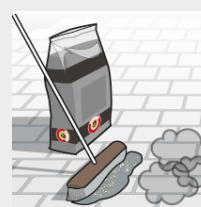
Fegen Sie das Fugenmaterial mit einem weichen Besen in die Fugen. Fegen Sie längs der Fugen und diagonal zu den Fugen, bis diese vollständig gefüllt sind.
