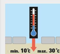
Während des Verfüllens der Fugen und an den ersten Tagen danach müssen die Luft- und die Bodentemperatur mindestens 10 °C betragen.
