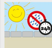
Das Wetter und der Boden müssen trocken sein, damit die Fugen vollständig aushärten können. Die Fugen vertragen in den ersten 24 Stunden keinen Regen – Nieselregen und Tau ausgenommen.
