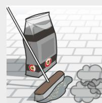
Fegen Sie das Fugenmaterial mit einem weichen Besen in die Fugen. Fegen Sie längs der Fugen und diagonal zu den Fugen, bis diese vollständig gefüllt sind.
