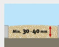
Verteilen Sie den Inhalt des Sackes mit einer Harke, sodass eine mindestens 30 - 40 mm dicke, ebene Schicht entsteht.
