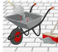
Mischen Sie das Fugenmaterial mit einer Schaufel in einem Mörtelkübel oder einer Schubkarre, damit die mineralischen Zusatzstoffe gut mit dem Quarzsand vermischt werden. Vermengen Sie nicht mehr als den Inhalt von zwei Säcken auf einmal.
