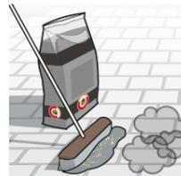
Fegen Sie das Fugenmaterial mit einem weichen Besen in die Fugen. Fegen Sie diagonal zu den Fugen, bis diese vollständig gefüllt sind.
