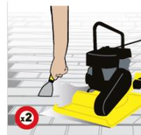
Neue Beläge müssen zweimal mit einer Rüttelplatte bearbeitet werden. Versehen Sie die Rüttelplatte mit einer Gummimatte, damit der Belag nicht beschädigt wird.
